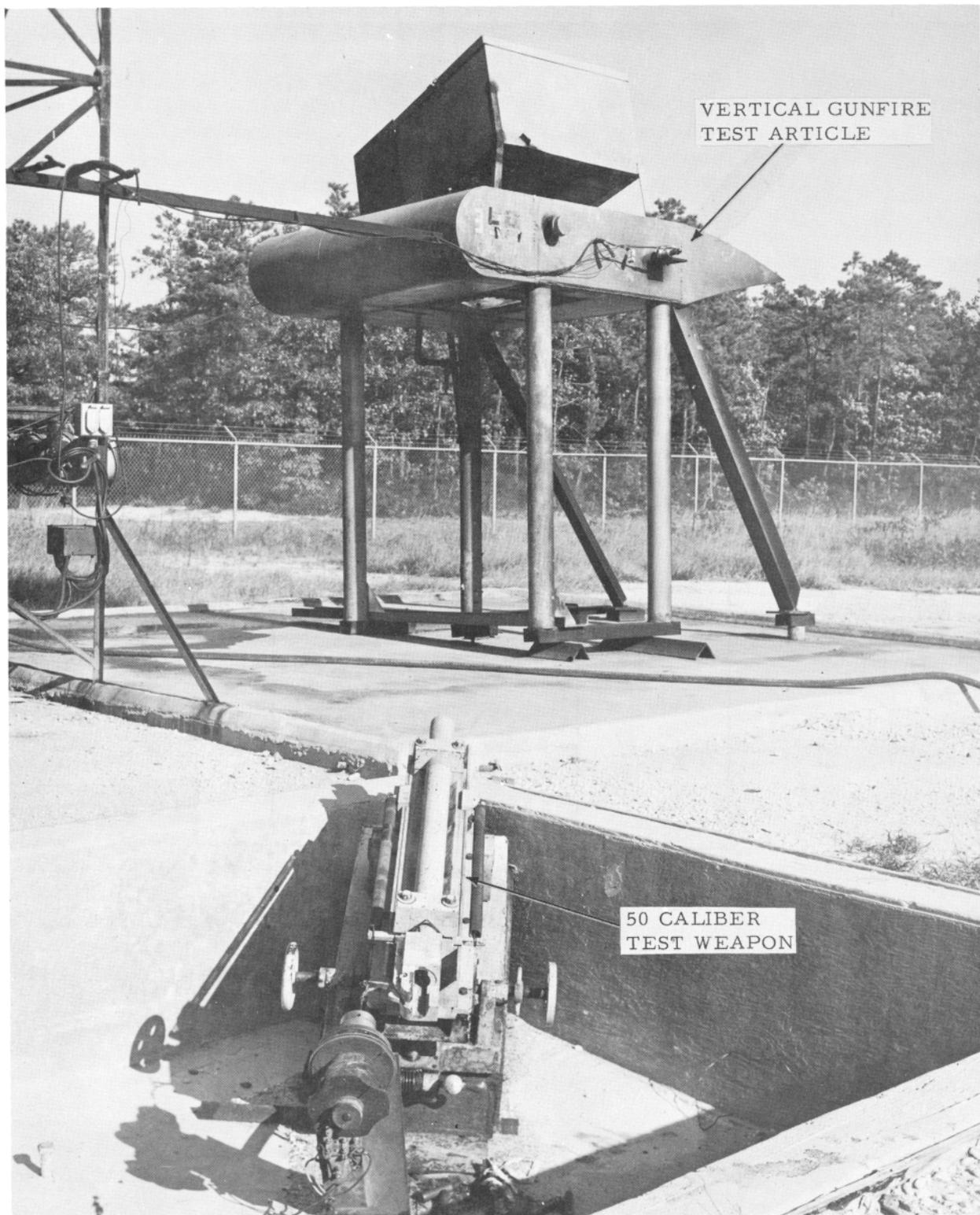
FIGURE 14. VERTICAL GUNFIRE TEST ARTICLE AND WEAPON LOCATION
