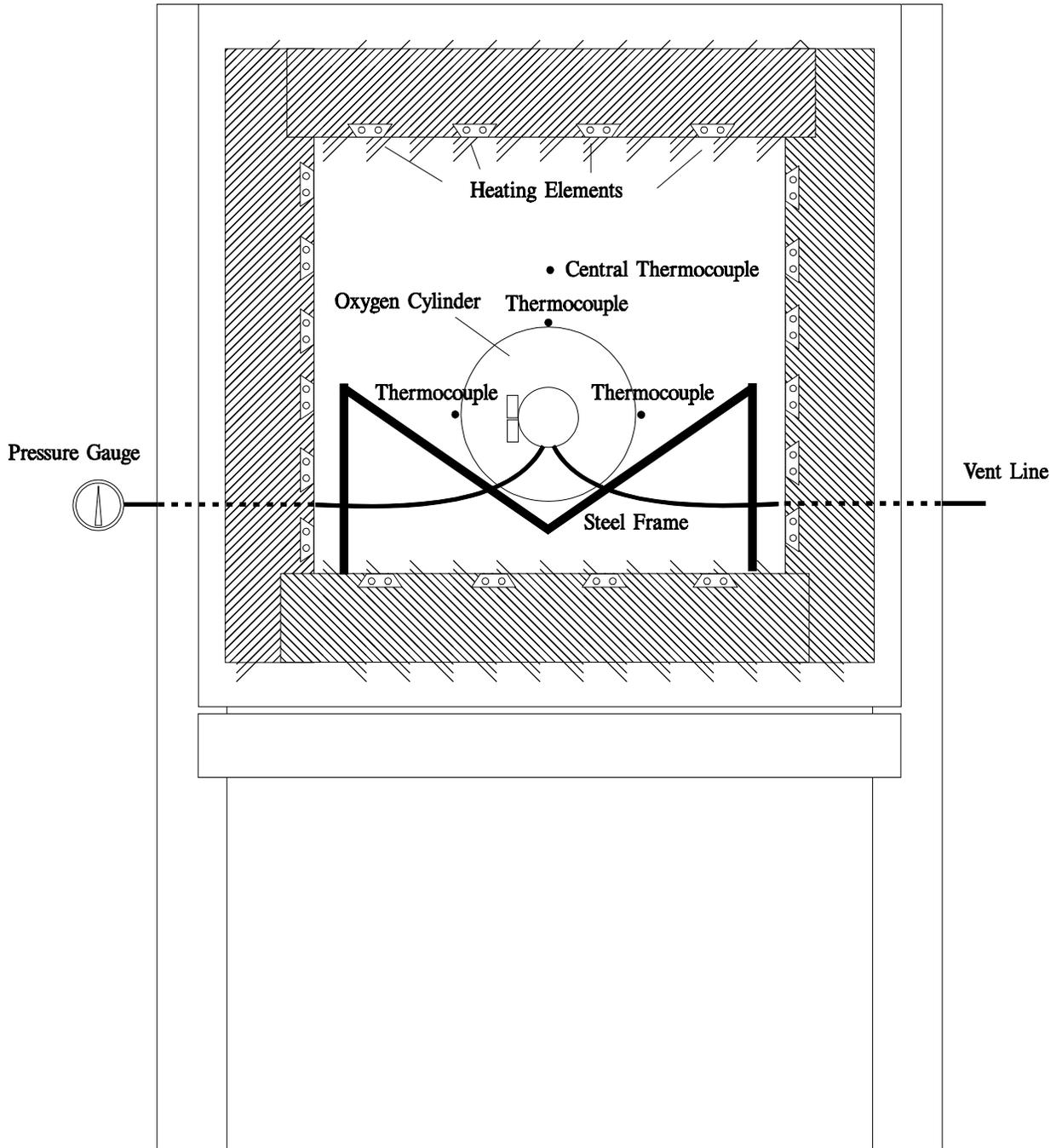
FIGURE 1. TEST FURNACE
