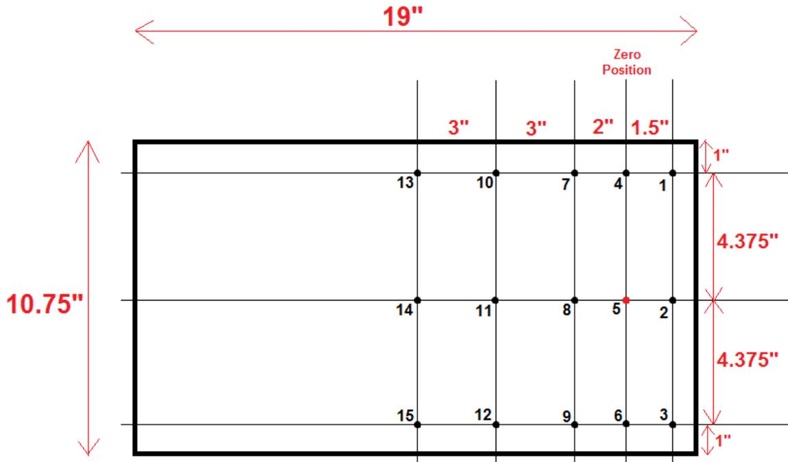
Figure 7. Thermocouple array dimensions
