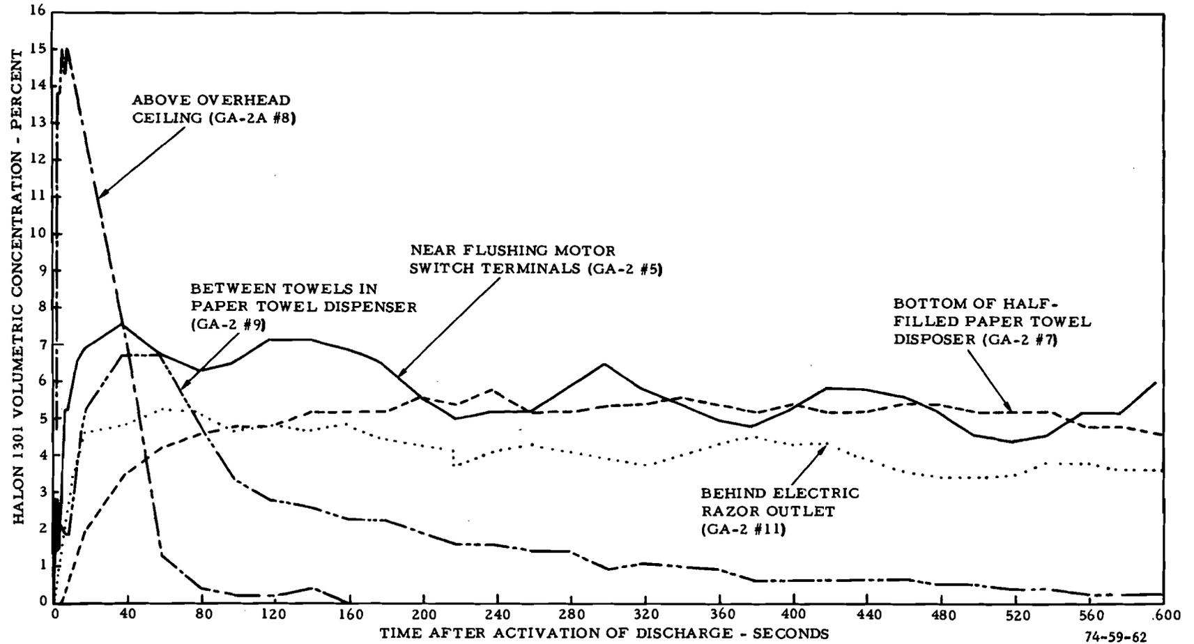
FIGURE 62. HALON 1301 CONCENTRATION-TIME PROFILES AT POTENTIAL IGNITION AND FIRE AREAS IN THE LAVATORY (DOOR OPEN) FOR THE MODULAR SUPPRESSION SYSTEM (TEST 17)
