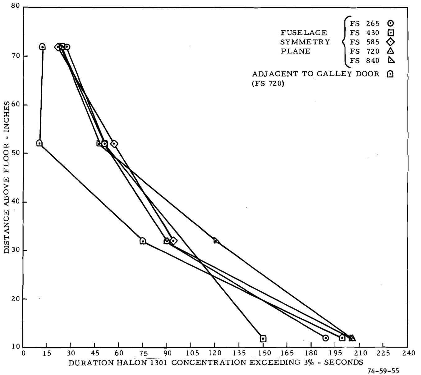
FIGURE 55. LOSS OF HALON 1301 FROM CABIN AFTER GALLEY EXIT DOOR
