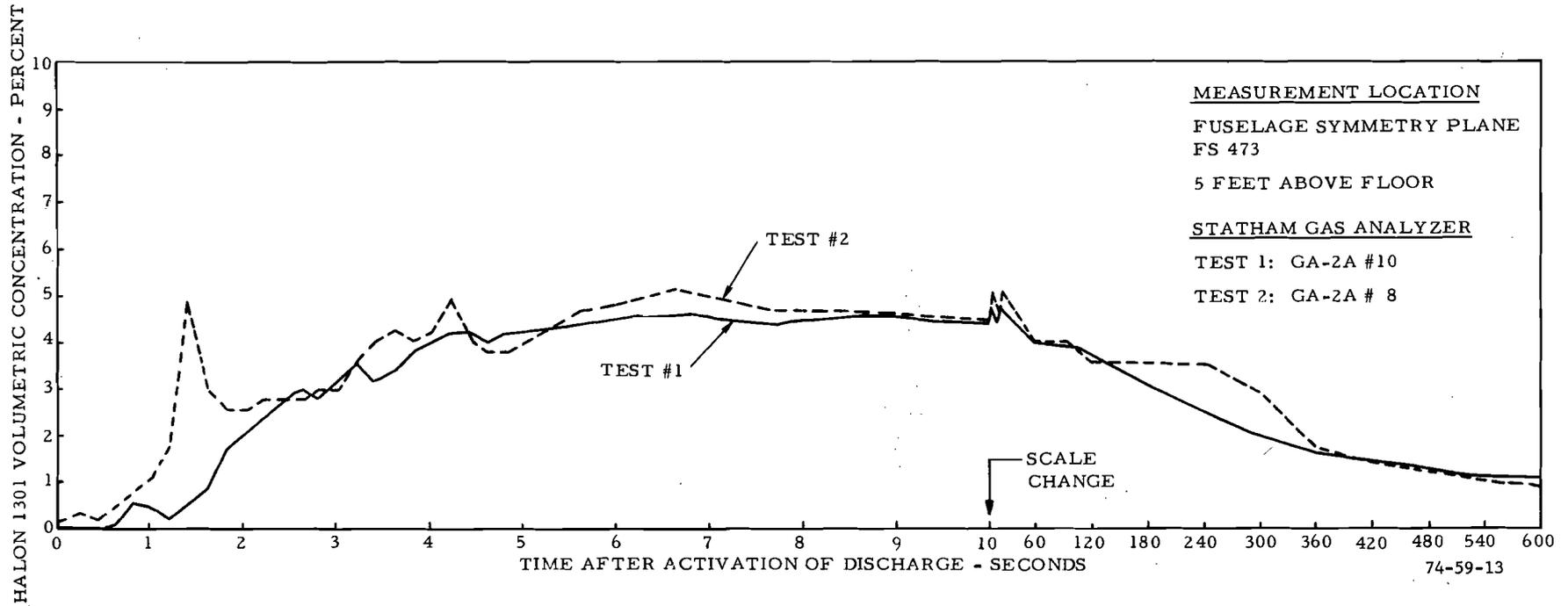
FIGURE 13. REPEATABILITY BETWEEN TESTS OF THE HALON 1301 CONCENTRATION-TIME PROFILE FOR THE MODULAR SUPPRESSION SYSTEM
