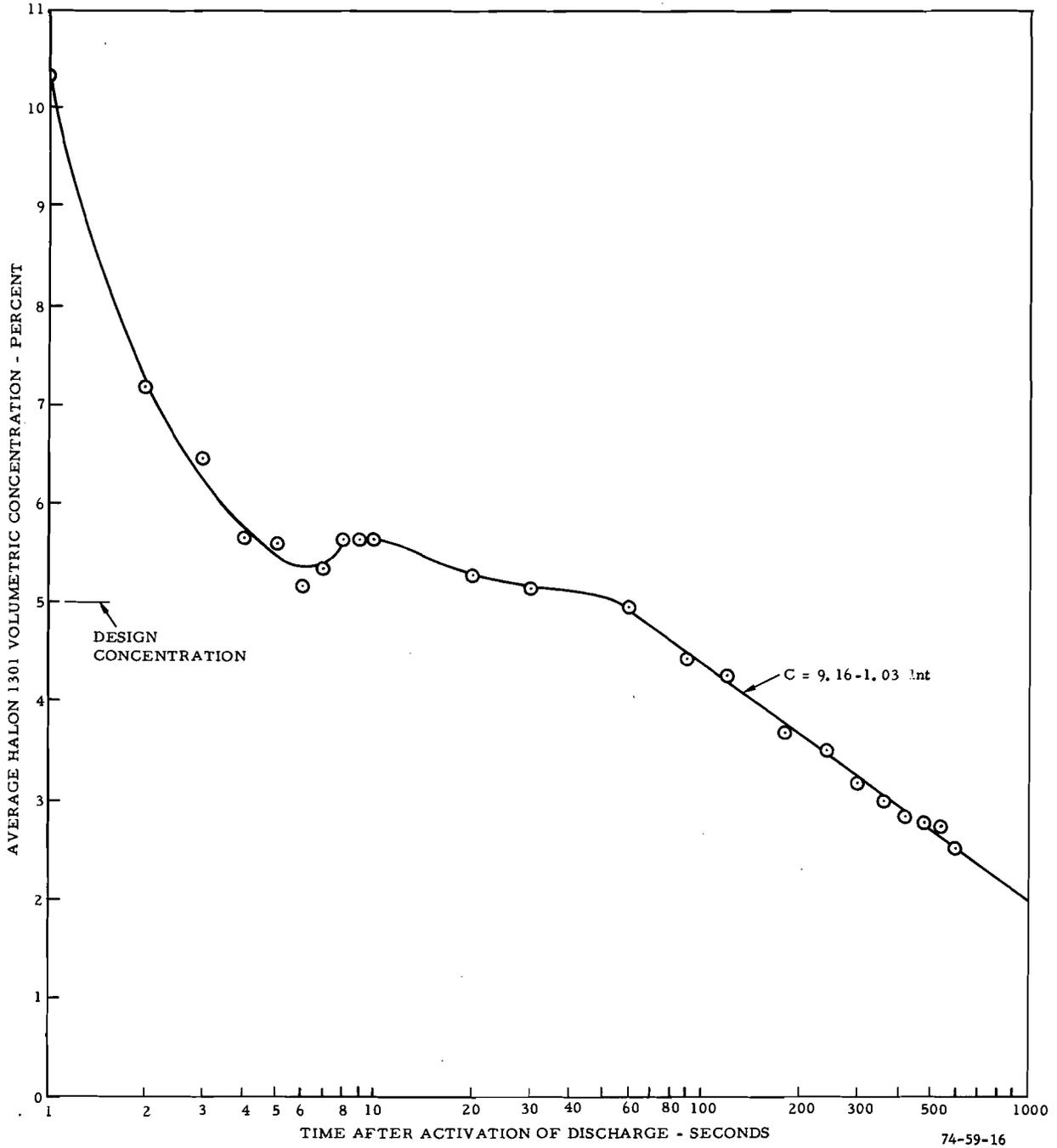
FIGURE 16. AVERAGE HALON 1301 CONCENTRATION BETWEEN THE FLOOR AND CEILING IN THE FUSELAGE SYMMETRY PLANE AT FS 540 OVER THE DURATION OF TEST 2
