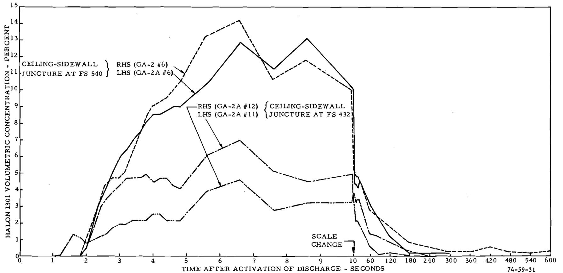
FIGURE 31. SYMMETRY OF HALON 1301 CONCENTRATION HISTORY AT THE CEILING FOR THE PERFORATED TUBE SUPPRESSION SYSTEM (TEST 7)
