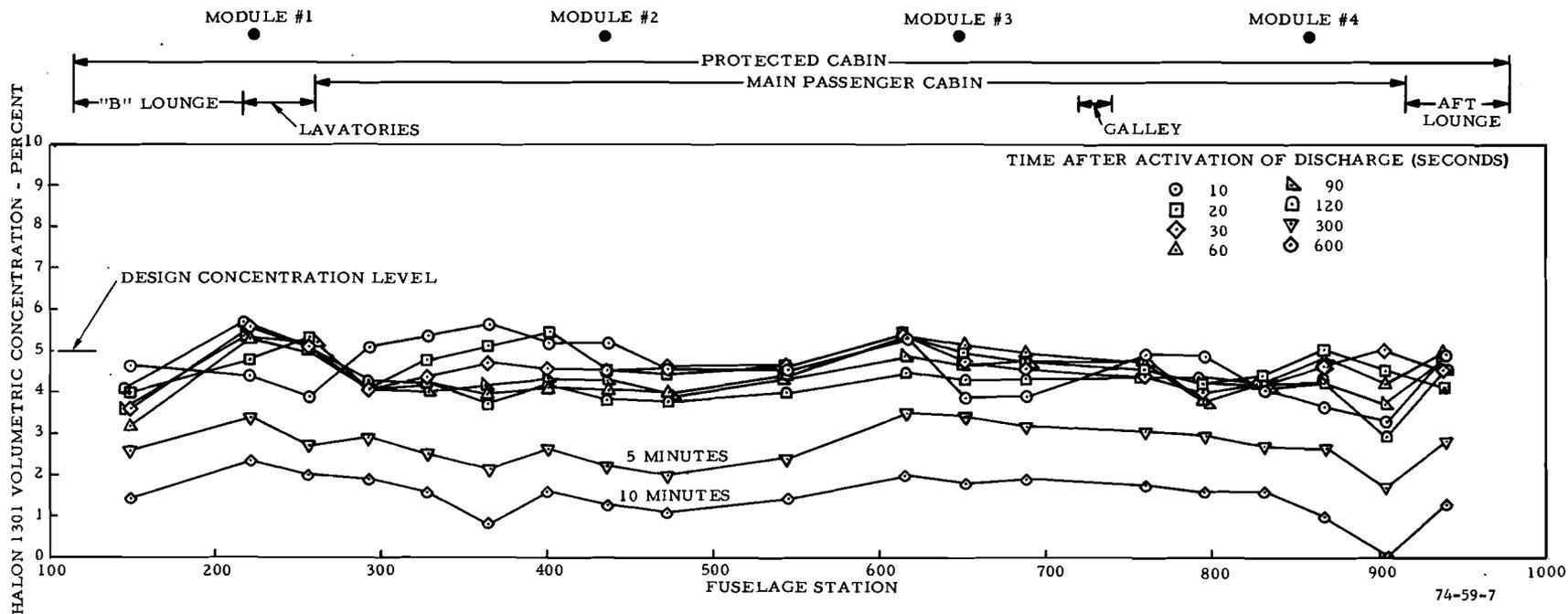
FIGURE 7. CONCENTRATION OF HALON 1301 ALONG THE FUSELAGE SYMMETRY PLANE AT A DISTANCE OF 5 FEET ABOVE THE FLOOR FOR THE MODULAR SUPPRESSION SYSTEM (TEST 1)
