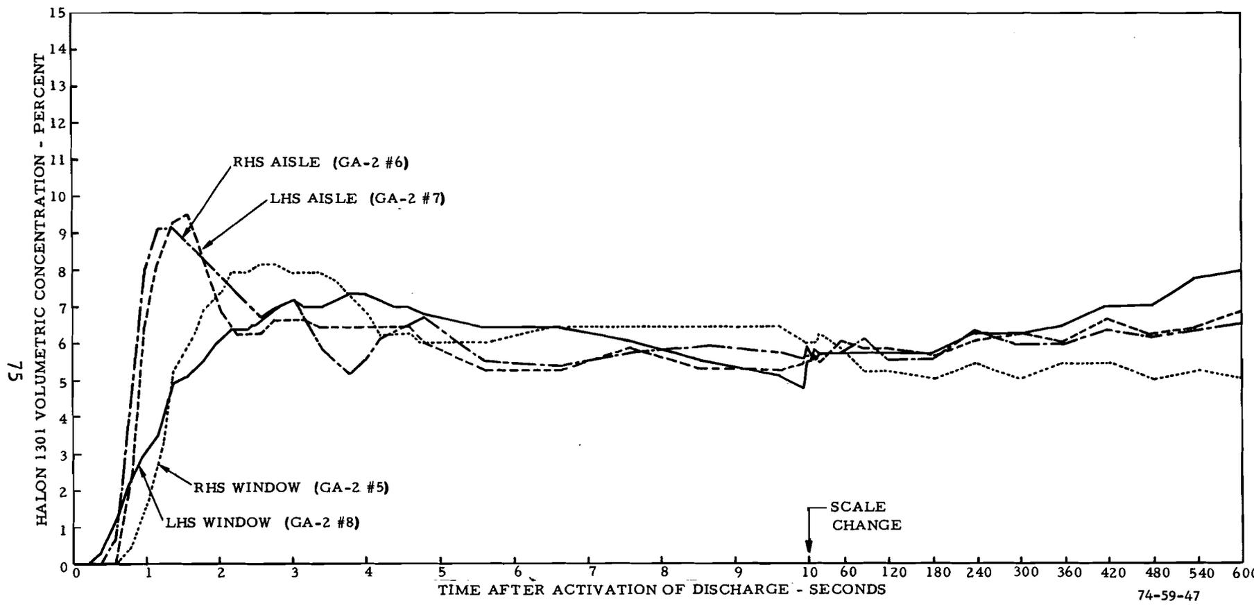
FIGURE 47. HALON 1301 EXPOSURE LEVEL FOR SEATED PASSENGERS AT FUSELAGE STATION 540 FOR THE MODULAR SUPPRESSION SYSTEM (TEST 10)
