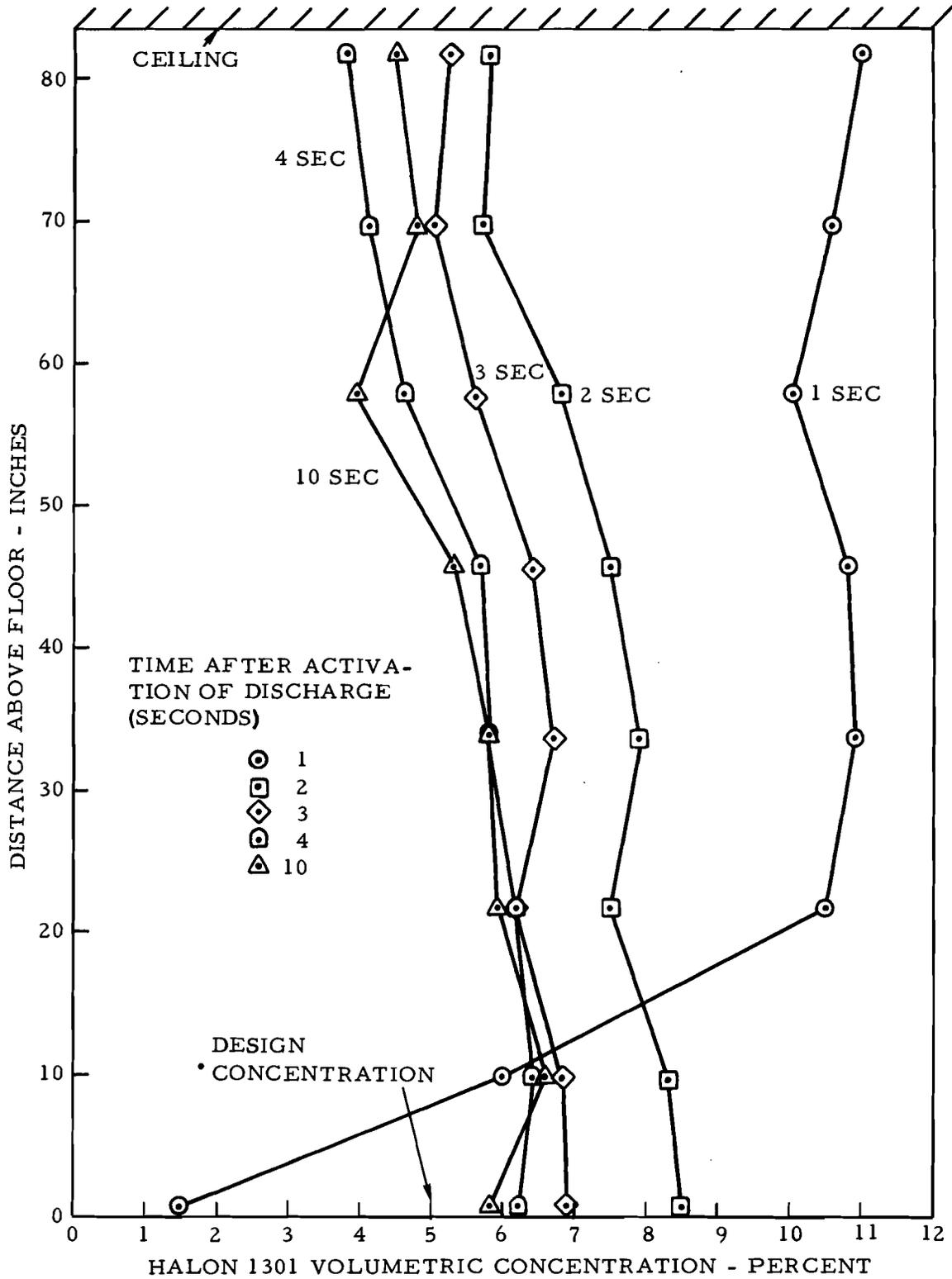
FIGURE 14. VERTICAL DISTRIBUTION OF HALON 1301 AT FUSELAGE STATION 540 IMMEDIATELY AFTER DISCHARGE OF THE MODULAR SUPPRESSION SYSTEM (TEST 2)
