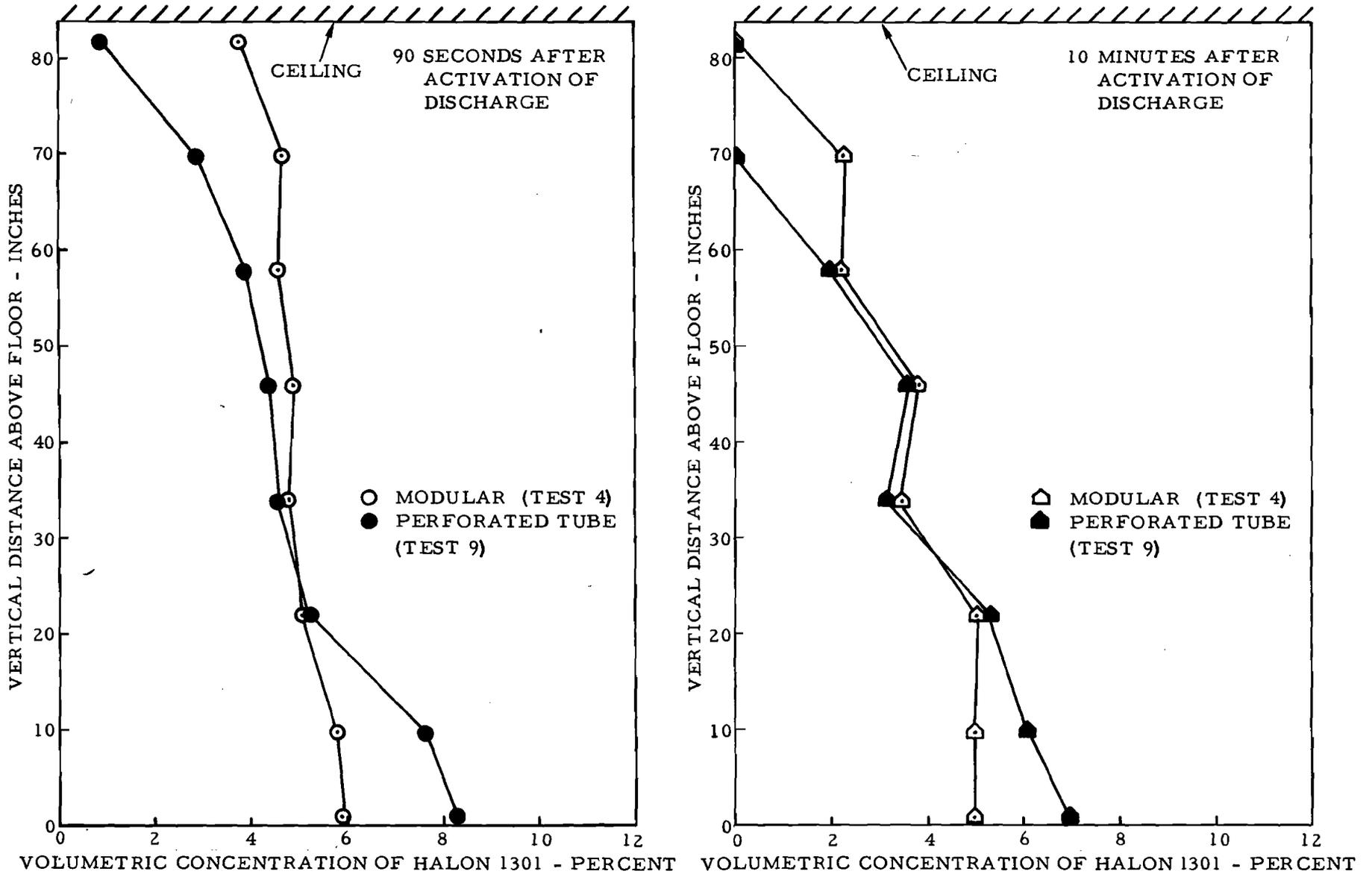
FIGURE 41. COMPARISON OF HALON 1301 STRATIFICATION AT FUSELAGE STATION 540 FOR THE MODULAR AND PERFORATED TUBE SUPPRESSION SYSTEMS
