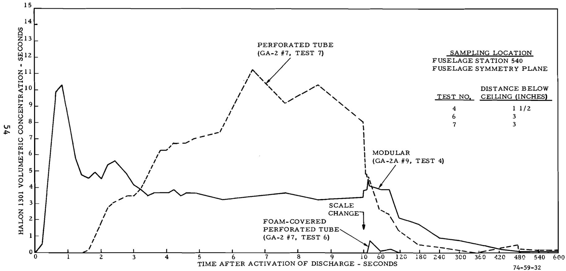
FIGURE 32. CONCENTRATION OF HALON 1301 DIRECTLY BELOW THE CEILING FOR THREE HALON 1301 DISPENSING SYSTEMS
