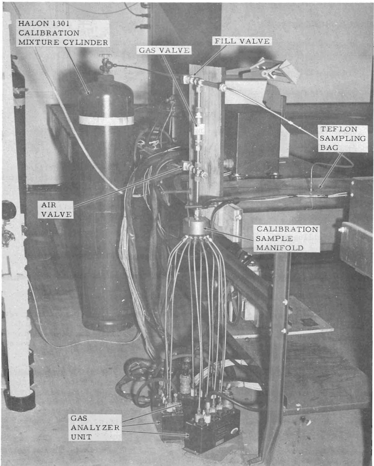
FIGURE A-2. SIDE VIEW OF HALON 1301 CONCENTRATION RECORDER CALIBRATION TEST SETUP
