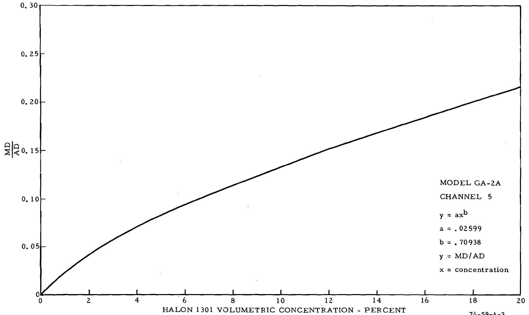
FIGURE A-3. TYPICAL HALON 1301 CALIBRATION CURVE FOR HALON 1301 CONCENTRATION RECORDER
