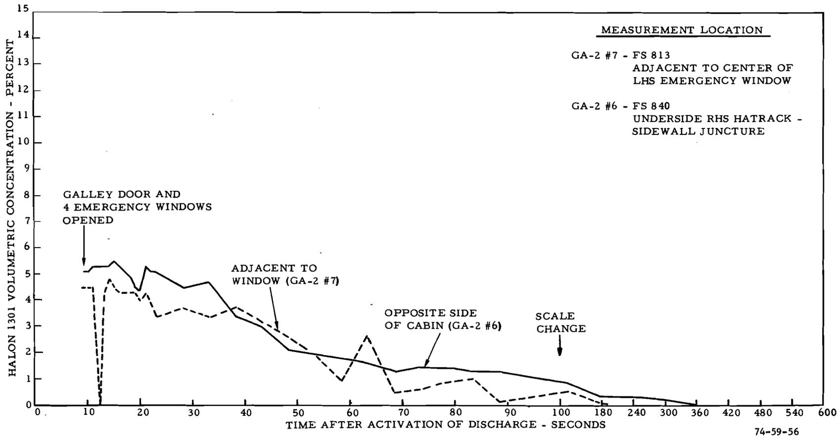
FIGURE 56. COMPARISON OF HALON 1301 CONCENTRATION-TIME PROFILE ADJACENT TO AN OPEN EMERGENCY WINDOW AND ON THE OPPOSITE SIDE OF THE CABIN FOR THE MODULAR SUPPRESSION SYSTEM (TEST 14)
