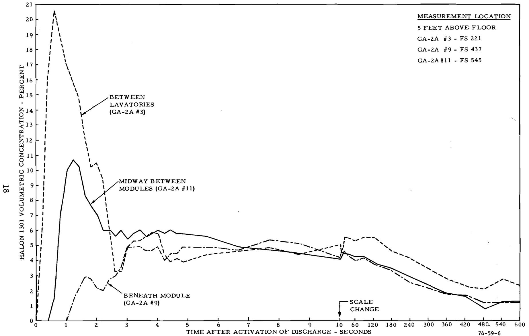
FIGURE 6. EXTREME HALON 1301 CONCENTRATION-TIME PROFILES IN THE FUSELAGE SYMMETRY PLANE FOR THE MODULAR SUPPRESSION SYSTEM (TEST 1)
