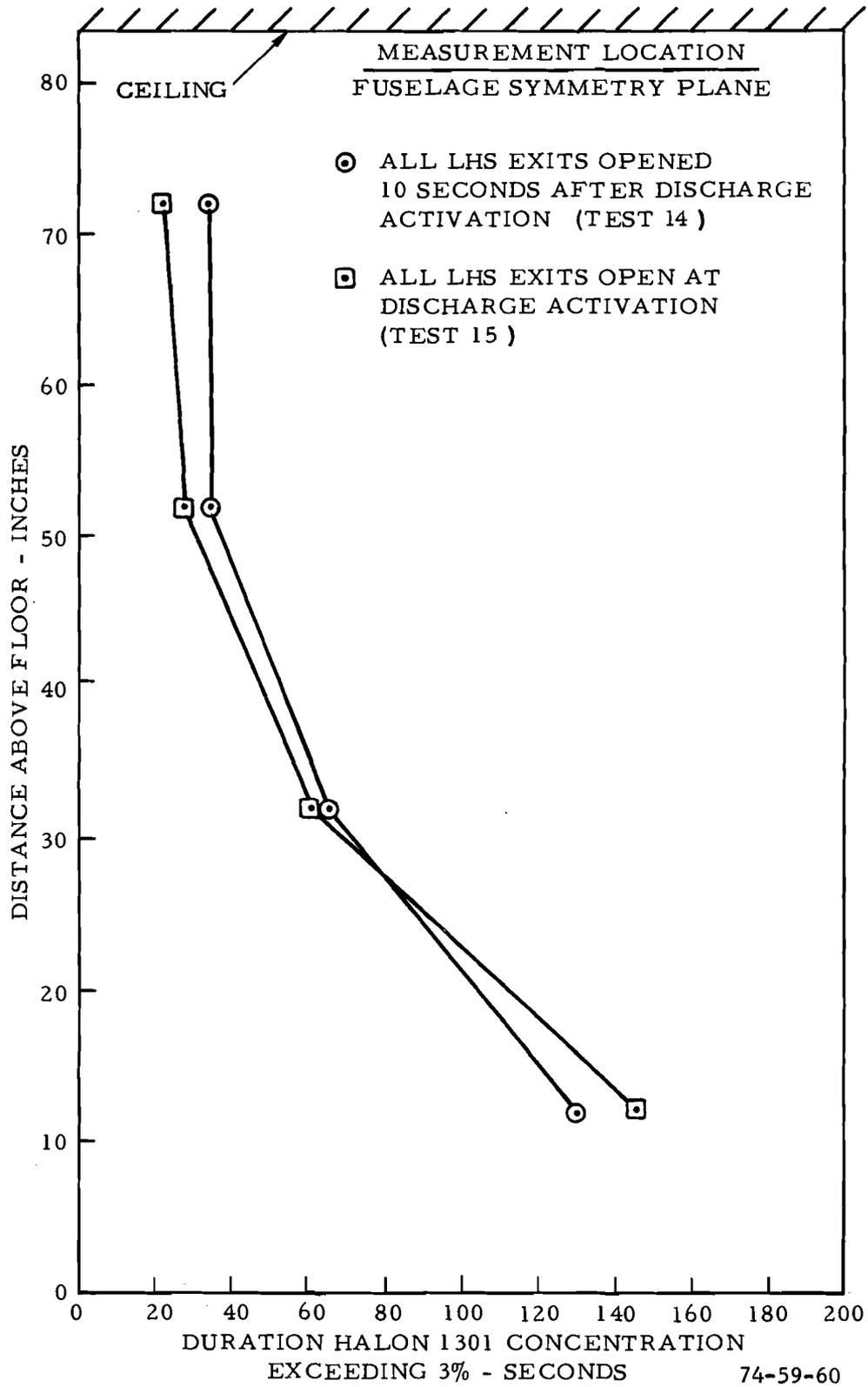
FIGURE 60. COMPARISON OF HALON 1301 PROTECTION AT FS 265 WHEN ALL LHS CABIN EXITS ARE OPENED BEFORE (TEST 15) AND AFTER (TEST 14) ACTIVATION OF THE MODULAR SUPPRESSION SYSTEM
