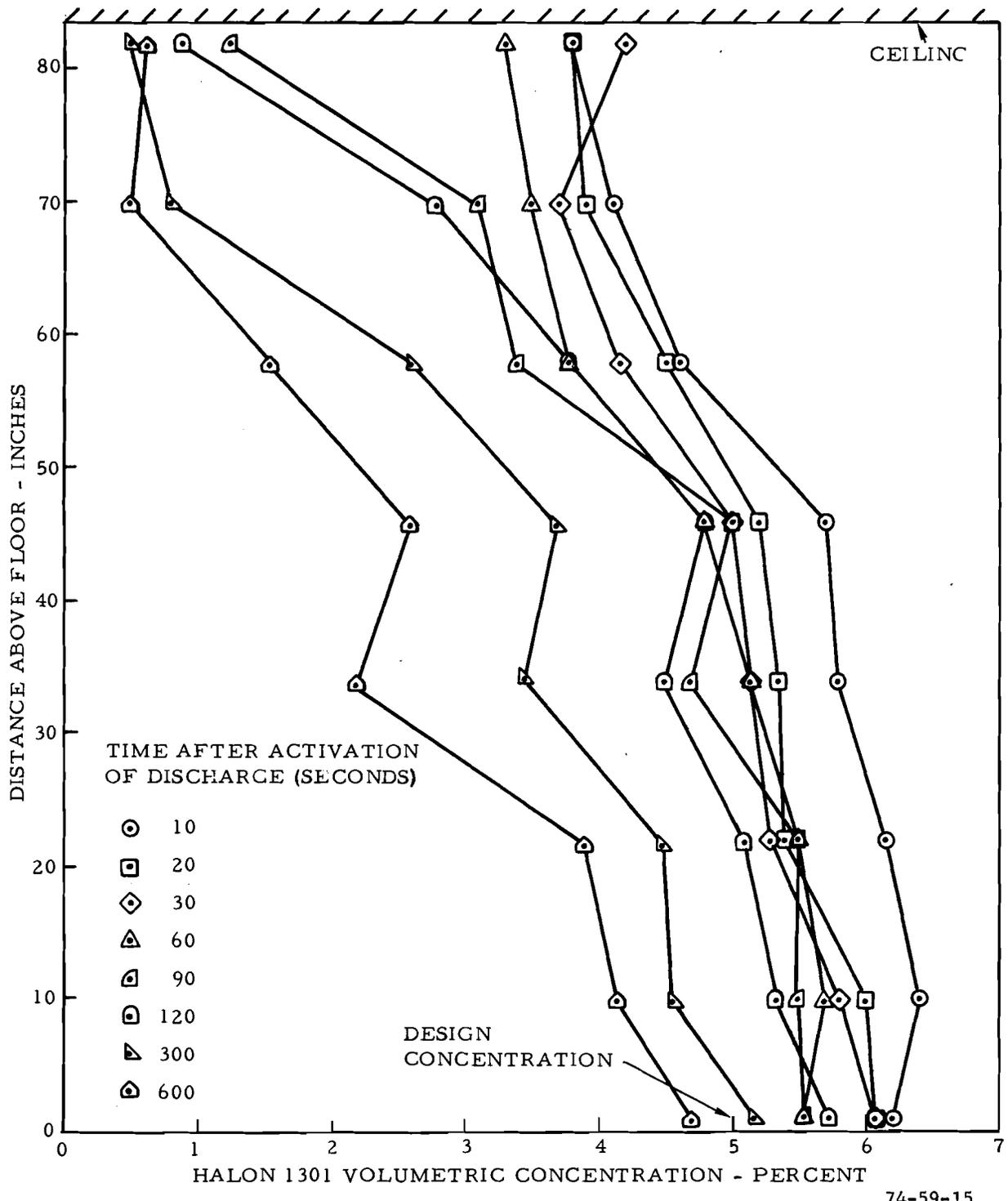
FIGURE 15. VERTICAL DISTRIBUTION OF HALON 1301 AT FUSELAGE STATION 540 FROM 10 SECONDS TO 10 MINUTES AFTER DISCHARGE OF THE MODULAR SUPPRESSION SYSTEM (TEST 2)
