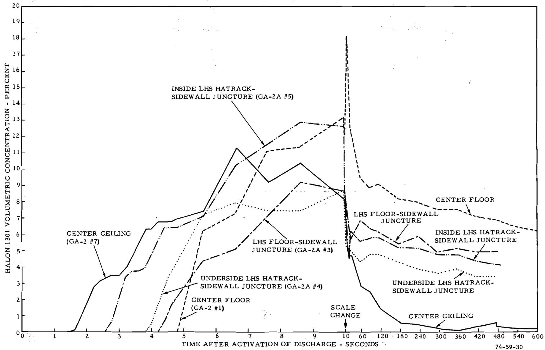
FIGURE 30. HALON 1301 CONCENTRATION AT PERIPHERAL CABIN LOCATIONS AT FUSELAGE STATION 540 FOR THE PERFORATED TUBE SUPPRESSION SYSTEM (TEST 7)
