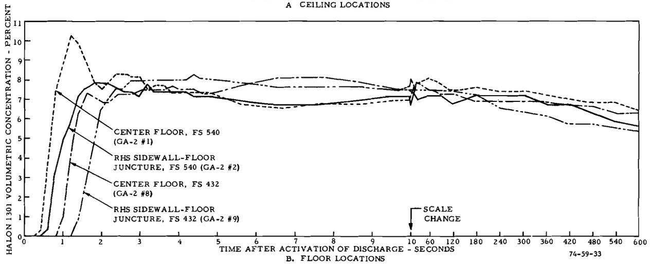
FIGURE 33. BUILDUP OF HALON 1301 CONCENTRATION FOR THE MODULAR SUPPRESSION SYSTEM (TEST 8)
