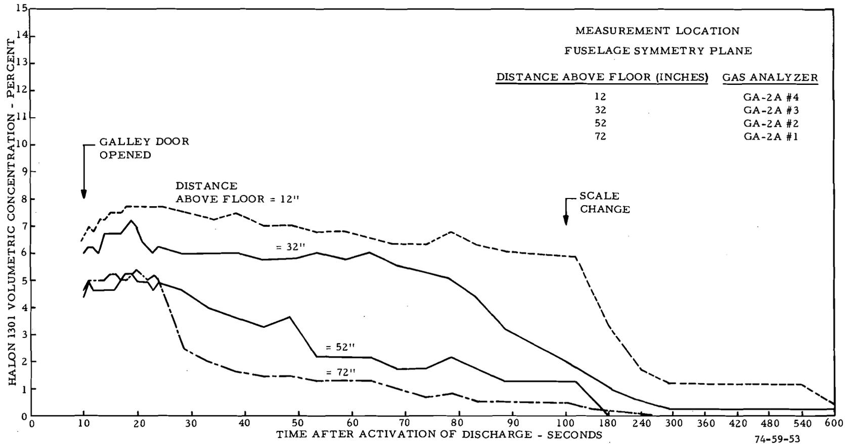
FIGURE 53. LOSS OF HALON 1301 AT FUSELAGE STATION 265 AFTER GALLEY DOOR OPENED 10 SECONDS AFTER ACTIVATION OF DISCHARGE (TEST 12)
