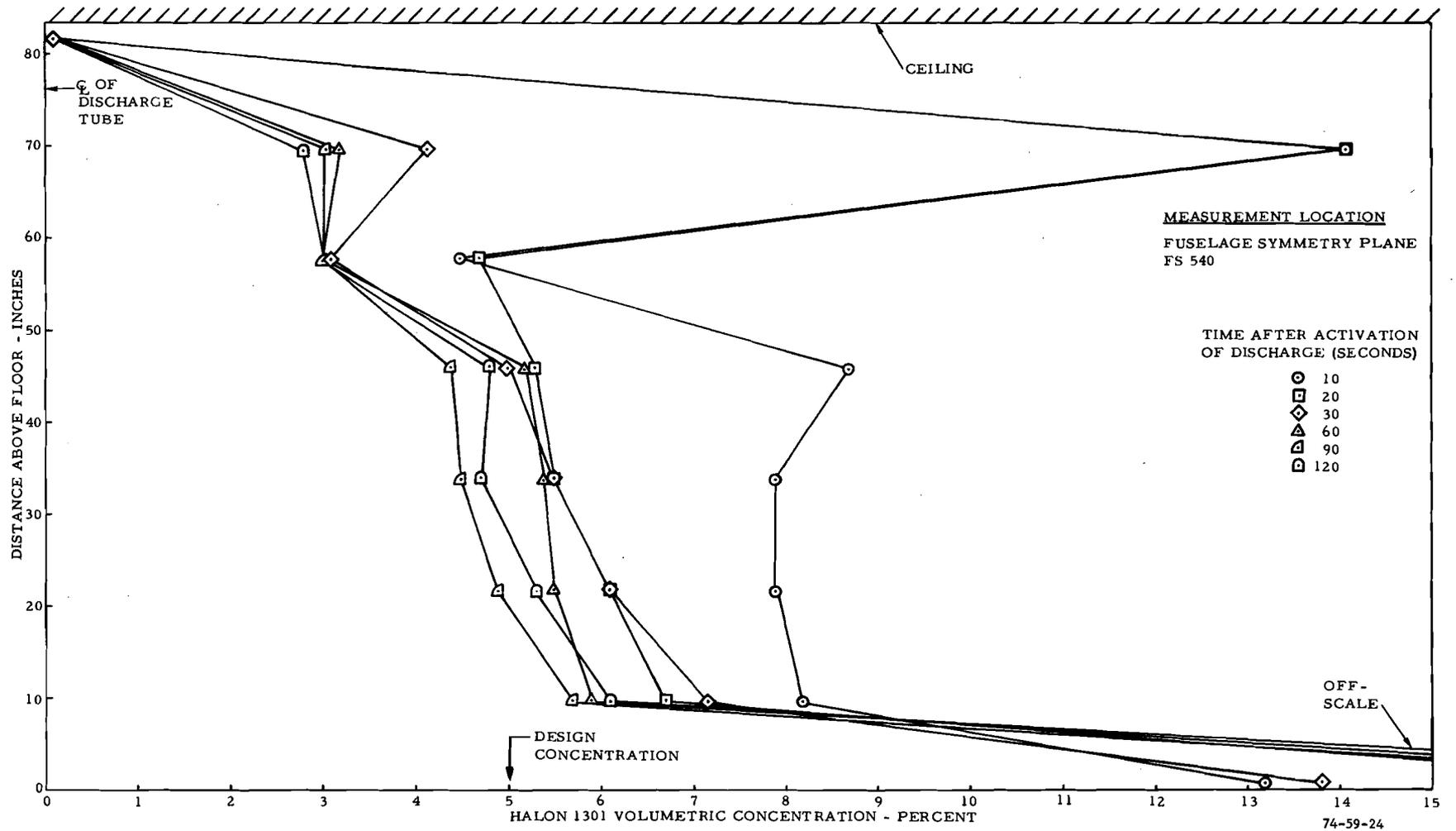
FIGURE 24. VERTICAL DISTRIBUTION OF HALON 1301 AT FUSELAGE STATION 540 FOR THE FOAM-COVERED PERFORATED DISCHARGE TUBE (TEST 5)
