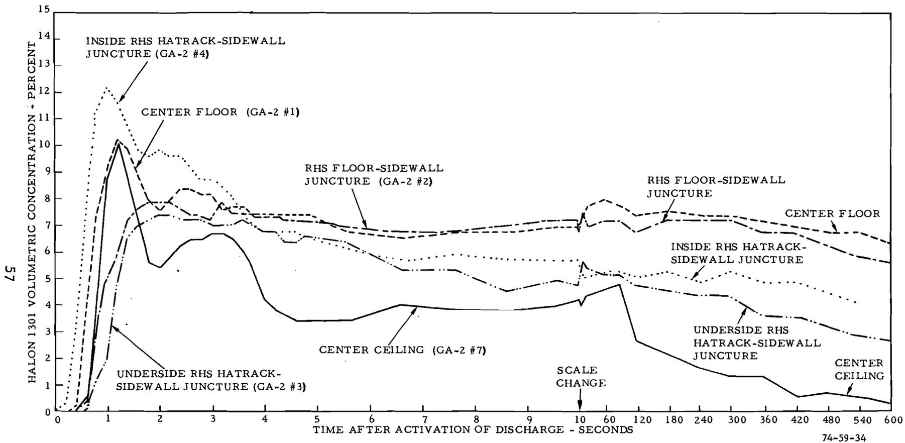
FIGURE 34. HALON 1301 CONCENTRATION AT PERIPHERAL CABIN LOCATIONS AT FUSELAGE STATION 540 FOR THE MODULAR FIRE-SUPPRESSION SYSTEM (TEST 8)
