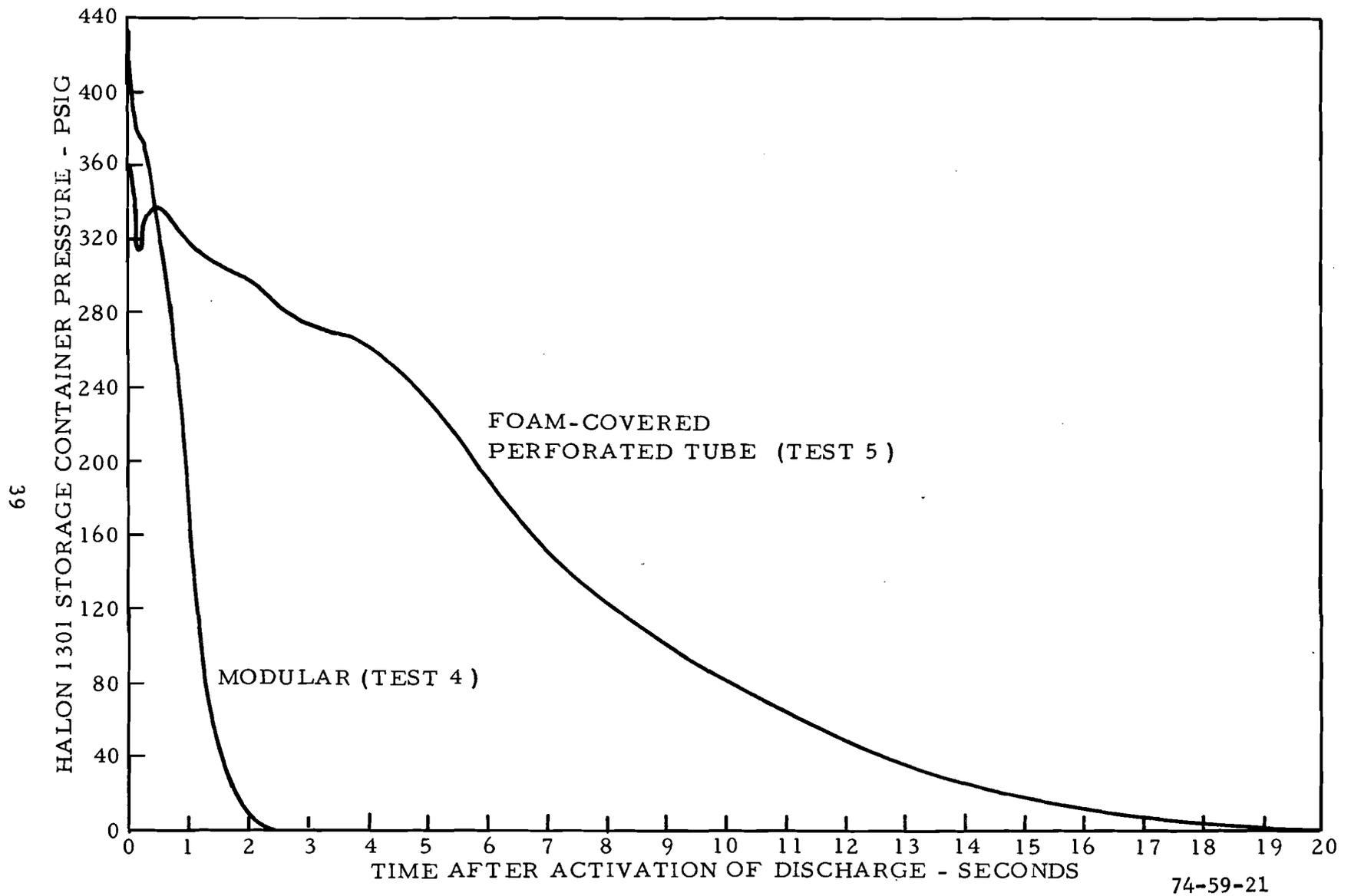
FIGURE 21. DROP-OFF IN HALON 1301 STORAGE CONTAINER PRESSURE AFTER DISCHARGE ACTUATION
