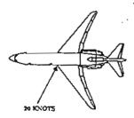
FUEL LOAD 900L KEROSENE + 20L PETROL IN 19M SQUARE TRAY SYSTEM CONFIGURATION SYSTEM COMPLETE IN CABIN UP TO LAST 4 ROWS OF PASSENGER SEATS
