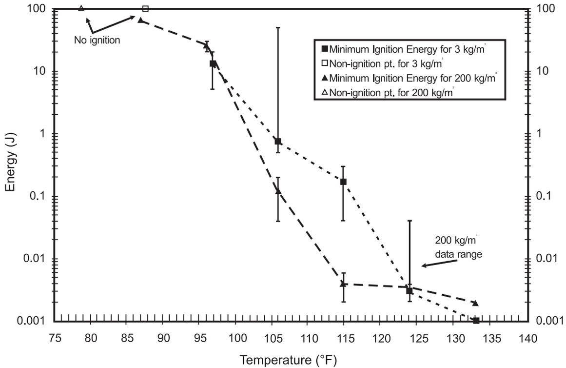
FIGURE 10. JET A MINIMUM IGNITION ENERGY VERSUS TEMPERATURE AT 0.585 atm
