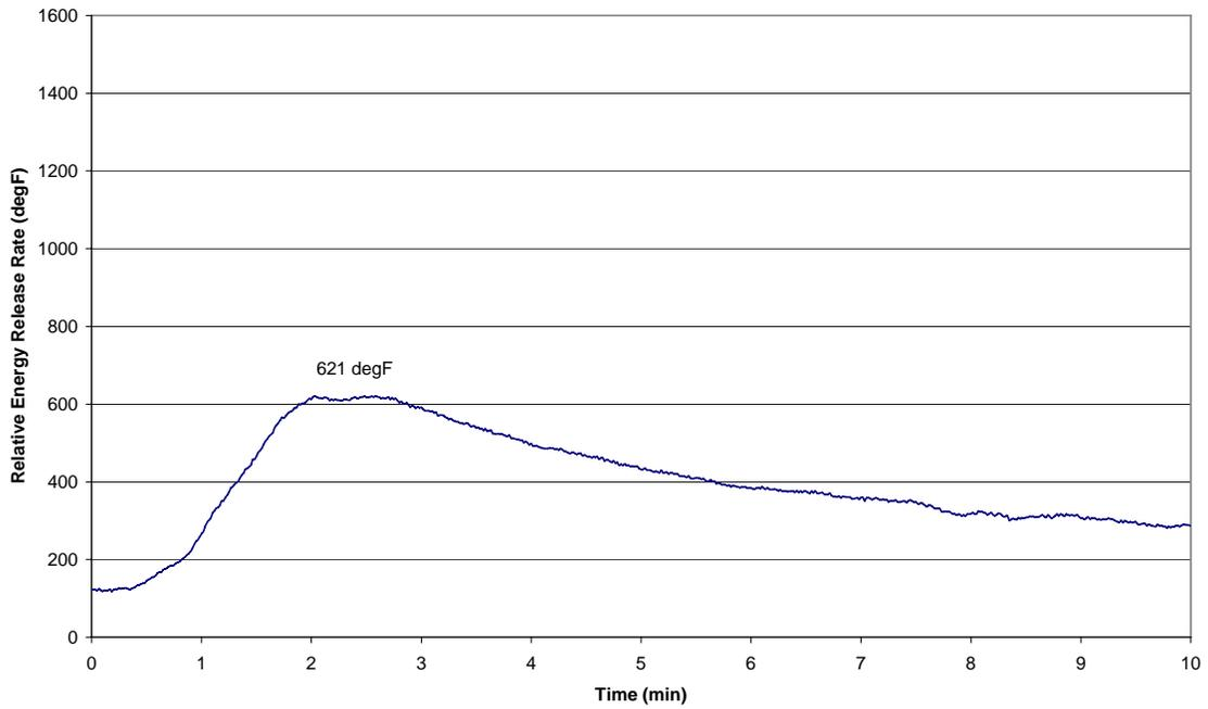
FIGURE 9. TEST 2—RELATIVE ENERGY RELEASE RATE VS TIME
