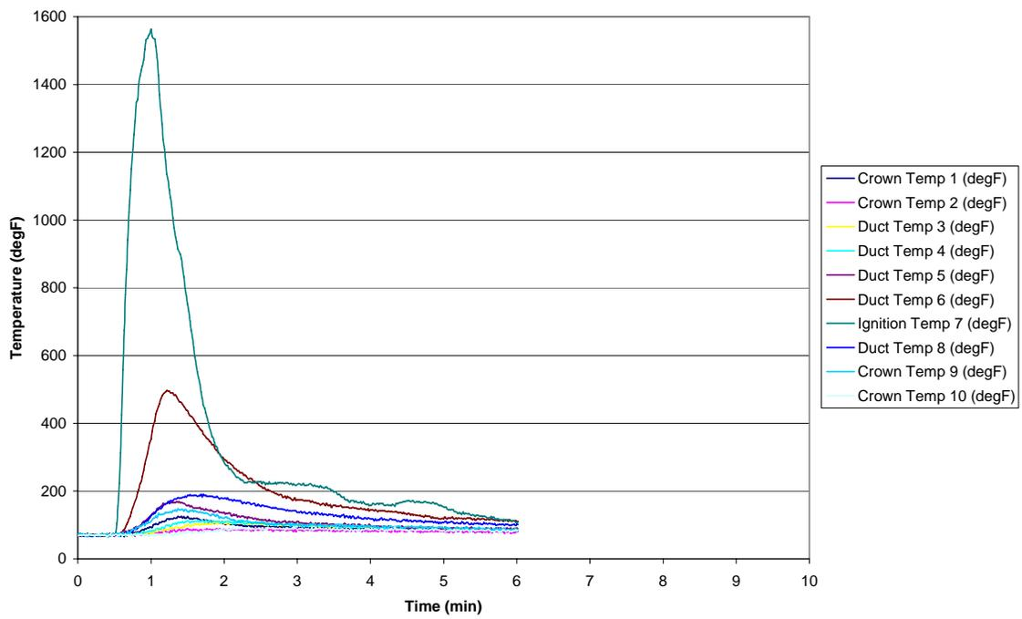
FIGURE 28. TEST 7—TEMPERATURE VS TIME
