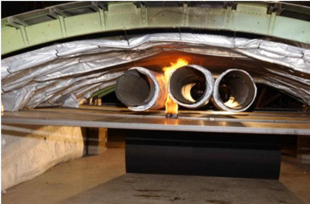
FIGURE 30. TEST 8—IN PROGRESS
