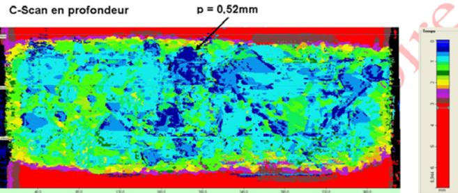
Epaisseur éprouvette = 3,02mm
