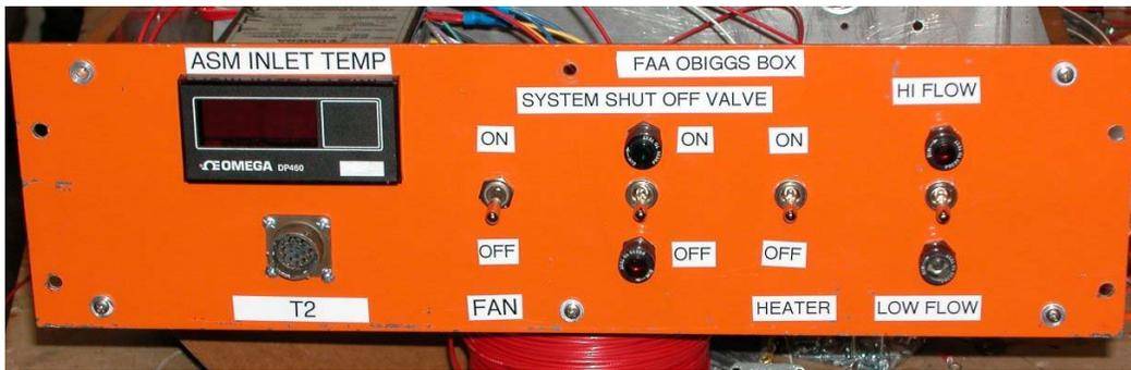
FIGURE 6. FRONT PANEL OF THE FAA OBIGGS CONTROL BOX
