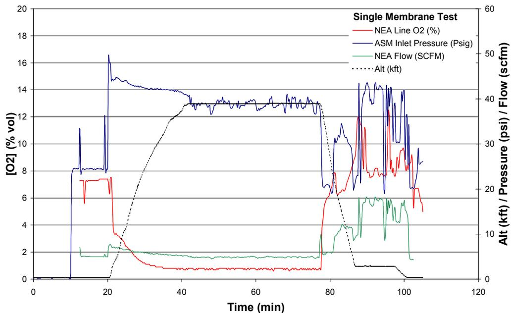
FIGURE 7. SYSTEM PERFORMANCE DATA FOR A SINGLE-MEMBRANE TEST
